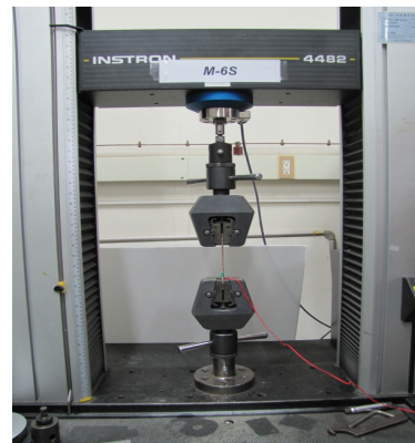
그림 1 만능시험기기를 통한 인장강도 실험
