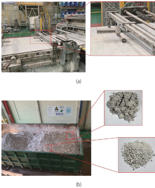
그림 2. (a) 엔지니어드스톤 제조과정 및 절삭공정에 따른 슬러지 발생 예시, (b) 발생된 폐기슬러지
