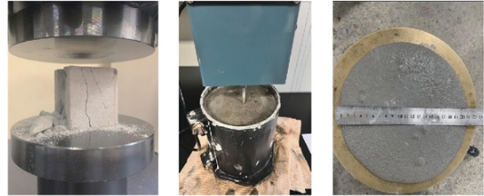
그림 4. 본 연구에서 수행된 모르타르 시편의 압축강도, 관입저항시험, 플로우 측정 예시
