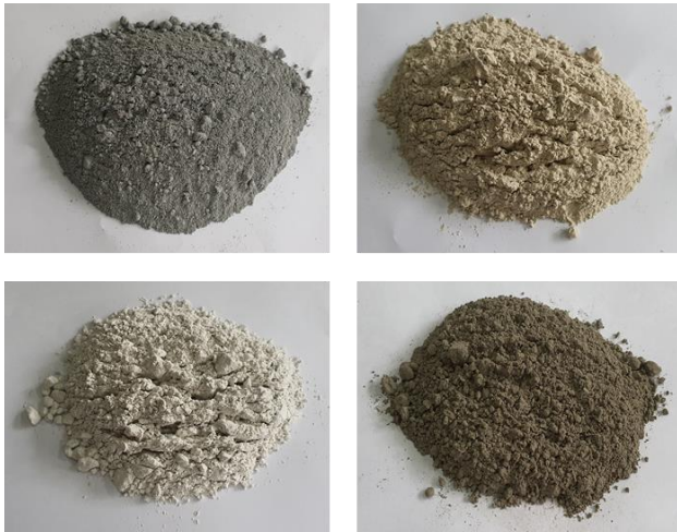
Fig. 2 Feedstocks of (a) Portland cement, (b) CSA, (c) Slag and (d) Silica fume
